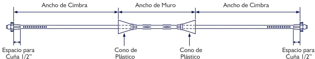
Los tirantes rompibles, son elementos de acero de alto carbón, que sirven para retener las paredes de la cimbra, antes, durante y después del vaciado del concreto. Tiene una capacidad de 1350 Kg. a la tracción cada uno (3000 Lbs.). Se fabrican para cualquier ancho de muro.
