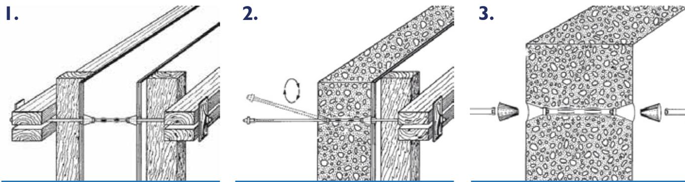
Para romper el tirante, una vez fraguado el elemento de concreto, bastará con doblar la punta y torcer.
